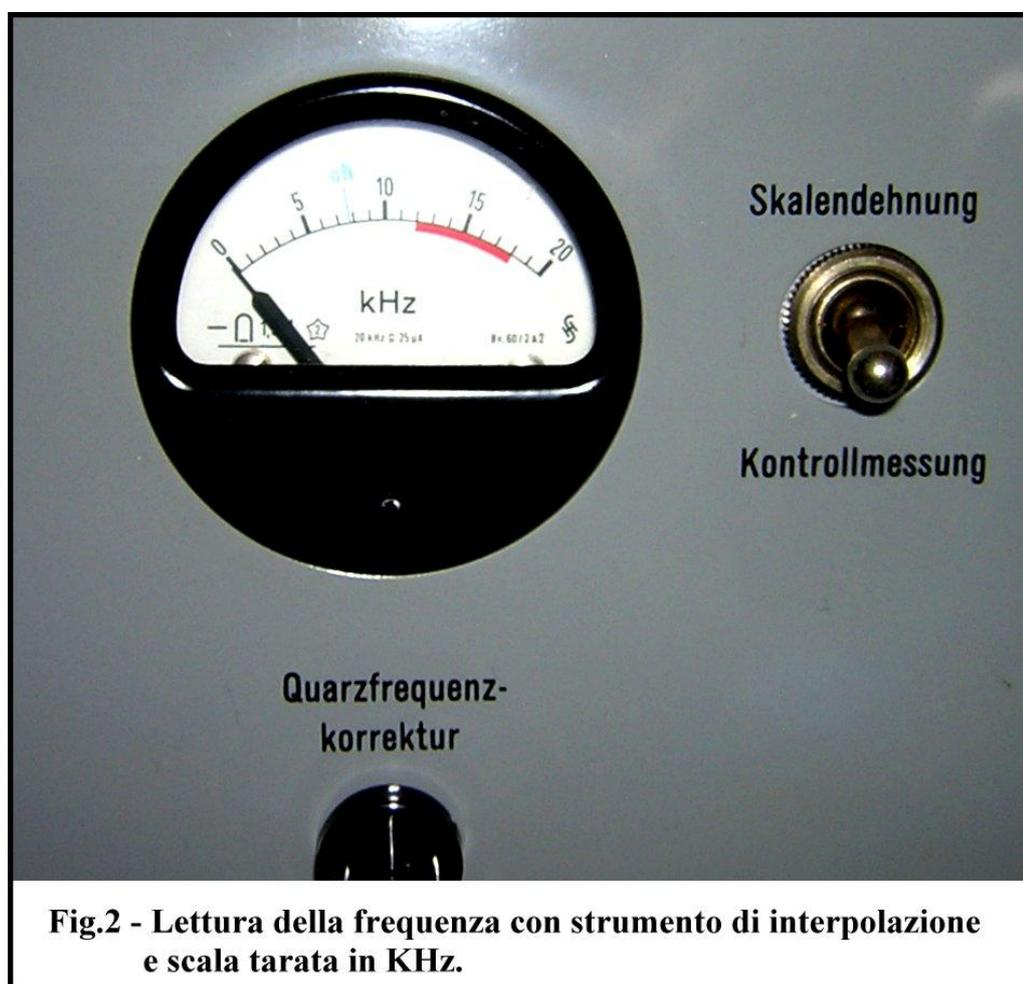
**Fig.2 - Lettura della frequenza con strumento di interpolazione e scala tarata in KHz.**
